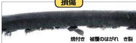
焼付き 被覆のはがれ き裂
